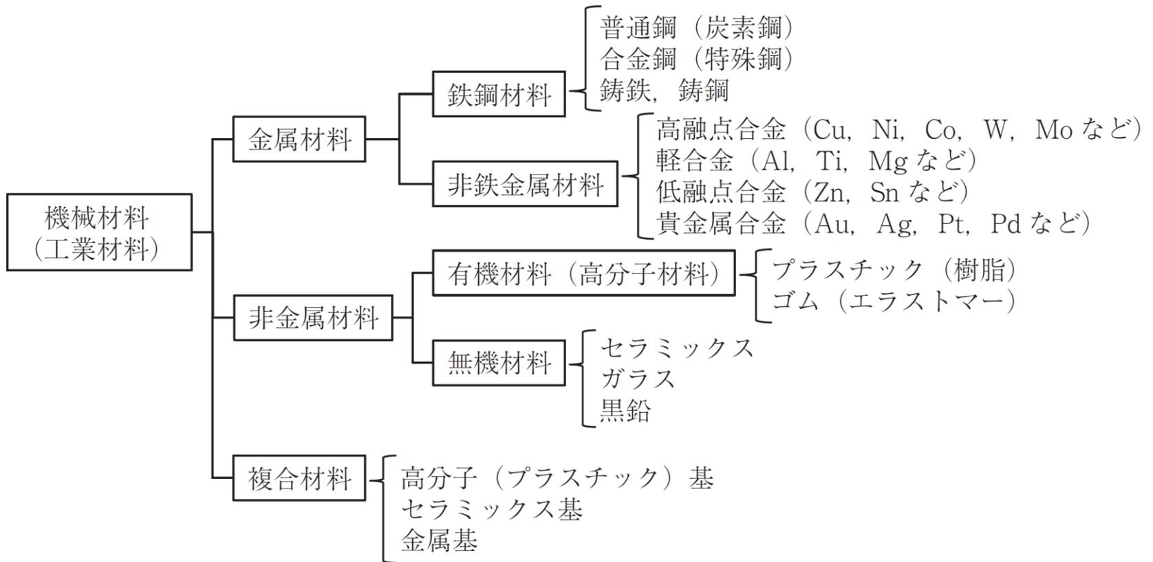
図 1.1 機械材料の分類
